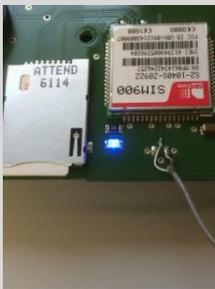
Die blaue LED signalisiert ob die Steuerung Verbindung zum Mobilfunknetz hat.
