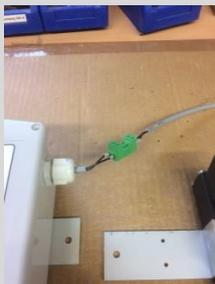
Jetzt muss die Akku Verbindung zu der Steuerung hergestellt werden. Die grünen Stecker mit einander verbinden.
