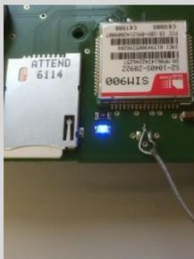
Zu Beginn muss eine SIM Karte in die Steuerung eingesetzt werden.
