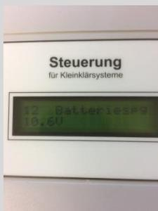
Jetzt sollte im Hauptmenü die Akkuspannung kontrolliert werden. Diese sollte zwischen 9,9 V und 11,3 V liegen.
