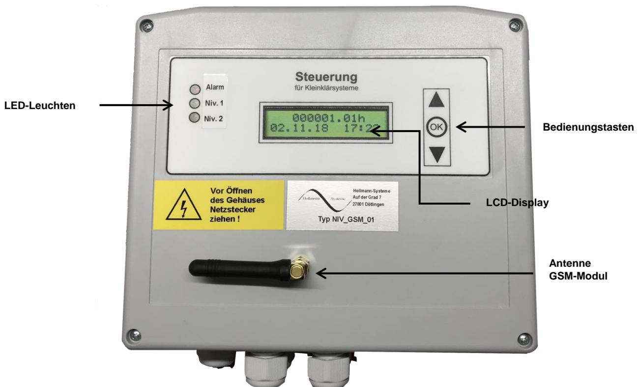
Auf der Vorderseite des Steuergerätes (Deckelplatine) befinden sich das mittig angeordnete, zweizeilige LCD-Display, drei LED-Leuchten und die Bedienelemente in Form von zwei Pfeiltasten und einer OK-Taste.
