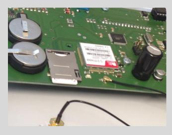
Die Steuerung muss jetzt auf geschraubt werden. Auf der Deckelplatine ist ein SIM Karten Halter angebracht. In diesem SIM Karten Halter muss die SIM Karte mit den Kantakten nach unten eingeschoben werden. So das sie hörbar einrastet.
